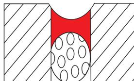
Durch die unten versetzte Fuge wird der Dichtstoff vor mech. Belastungen geschützt.
